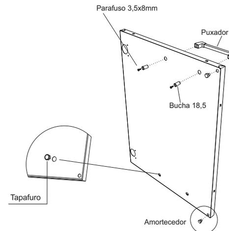
Coloque as buchas 18,5 nos furos indicados no desenho, logo em seguida os parafusos 3,5x8 e fixe os puxadores das portas, repita o mesmo procedimento com a gaveta. Coloque os tapafuros nas devidas furações. Caso necessário, realize a regulagem das portas através dos parafusos da dobradiça.
