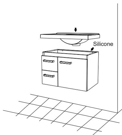
Desembale a cuba com cuidado. Aplique silicone nas bordas inferiores da cuba (como mostra a imagem) e posicione-a no tampo de forma com que o furo da cuba fique alinhado com o furo do tampo. Pressione de leve a cuba sobre o tampo para fixá-la, e espere o silicone secar de acordo com as recomendações do fabricante. Certifique-se de que está bem vedado antes de iniciar o uso do produto. Instale a torneira e a válvula da cuba, e está pronto para usar.
