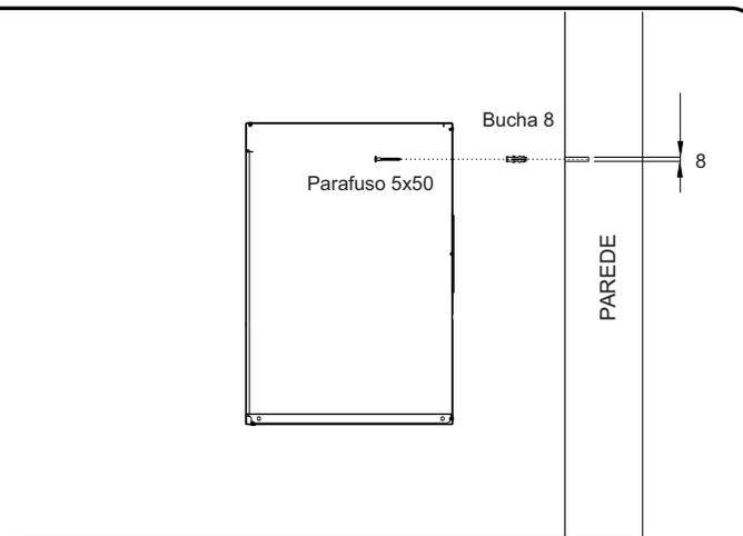
Posicione o toucador na parede de forma que esteja nivelado (utilize um nível) e marque com lápis os furos na parede, passando-o pelos furos do toucador. Afaste o toucador da parede e com uma trena ou metro confirme se as medidas entre as marcações estão conforme os furos do toucador. Fure a parede com broca n.8. Coloque a bucha 8 nos furos, posicione o toucador alinhando os furos com as buchas na parede. Fixe o toucador na parede com parafusos 5x50 conforme o desenho.
